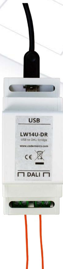
Der Anschluss an den DALI-Bus erfolgt über die beiden Schraubklemmen. Es sind für die Busleitungen jeweils zwei Klemmenpositionen vorgesehen. Die beiden Positionen in jeweils einem der Klemmenblöcke sind identisch, es muss also jeweils eine Leitung an einem der Klemmenblöcke angeschlossen werden. Die zusätzlichen Klemmen dienen dem einfacheren Durchschleifen des DALI-Bus.
